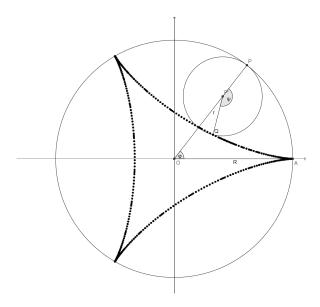
Die Steinersche Hypozykloide wird durch das Abrollen eines Kreises in einem größeren Kreis erzeugt. Dabei hat der größere Kreis den dreifachen Radius (R=3r) des kleineren Kreises (r). In der Ausgangslage liegt der kleinere Kreis auf der x-Achse und rollt dann auf der Bahn des größeren Kreises. Dadurch gilt für die Bögen:
