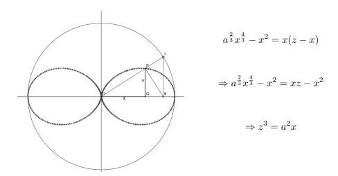
Setzt man nun  $x=\frac{a}{n}\Rightarrow z^3=\frac{a^3}{n}$ , also stellt der Würfel mit der Kantenlänge z=OB den n-ten Teil des Würfels mit der Kantenlänge a (= Kreisradius) dar. Um aus einer gegebenen Kurve die Seitenlänge des n-ten Teils des Würfels zu finden trägt man also auf der x-Achse den Wert  $\frac{a}{n}=OQ$  auf, sucht den Schnittpunkt zwischen
